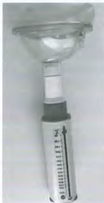
Figura 21-1. Medidor portátil del pico de flujo adaptado a la mascarilla nasobucal para la medición del pico flujo de tos.
