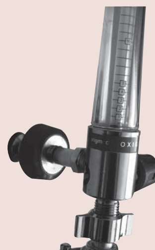
Figura 12.3. Modelo de flujómetro para suministro de oxígeno
