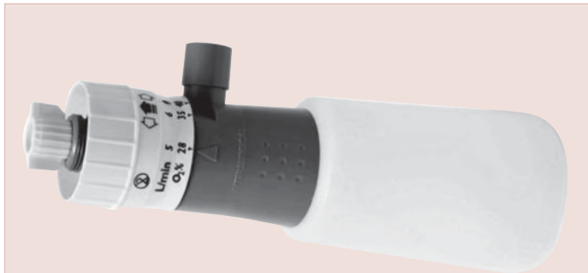
Figura 17.6. Nebulizador con anillo o collar de Venturi. El sistema posee un anillo en la parte superior que gira modificando el tamaño de la ventana de succión. En la parte intermedia está el sistema de regulación de la temperatura y en la parte inferior el vaso de nebulización.
