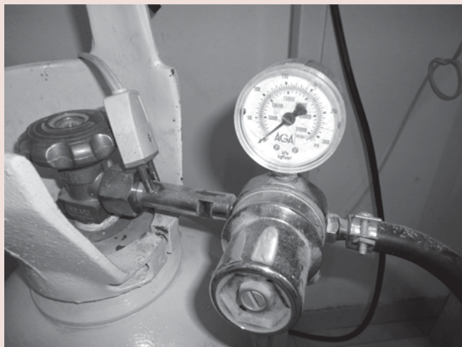
Figura 12.1. Regulador de alta presión y flujo constante (manómetro de flujo directo). Existen modelos de rosca (a la izquierda) y de yugo (a la derecha)
