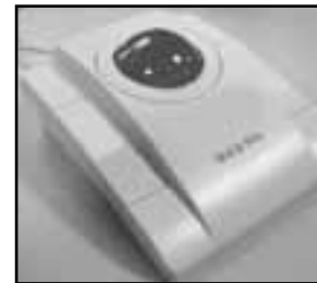
Figura 1.15 El trackball es un dispositivo apun- tador sustituto del ratón.
