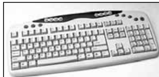
Figura 1.13 El teclado es el dispositivo para entrada de datos más utilizado en una computadora.
