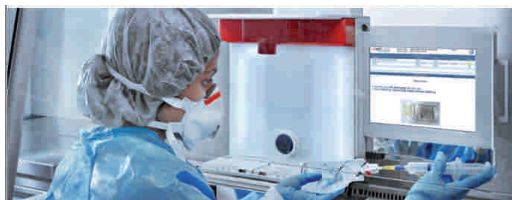
Fig 5. Cabina de Flujo Laminar en funcionamiento con software (detalle pantalla, cámara, balanza)
